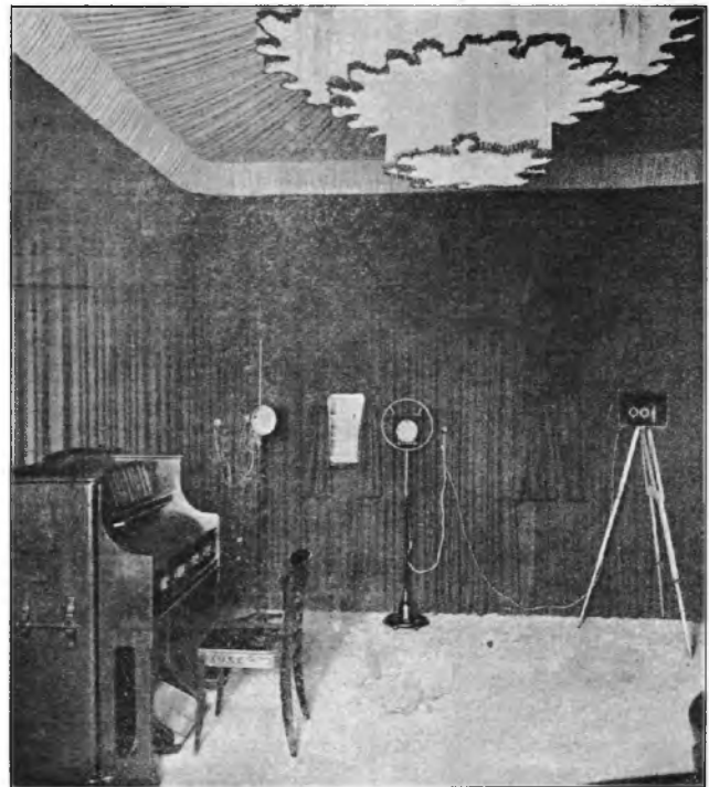
De kathodophone in gebruik bij het omroep-station te München. De kleine klankzaal met links: geluidstrechter van de kathodophone, midden een korrel-microfoon en geheel rechts een soortgelijke microfoon als bij de Engelsche stations in gebruik is.
